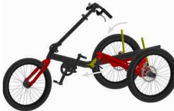
7. Lösen Sie den unteren Schnellspanner (1) am Vorbau des TRIGO UP und kippen Sie den Lenker nach hinten bzw. lösen Sie die Klemmung am Lenker des TRIGO und kippen Sie die Lenkerenden nach hinten.
